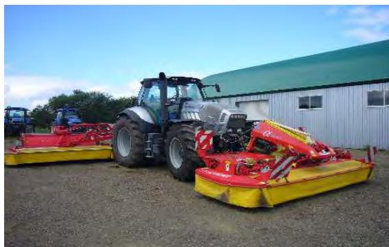
イタリア製のトラクターに３連モアコンディショナーをセット
