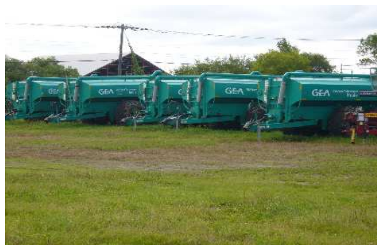
スラリー散布用のタンク車（容量：15 トン）
